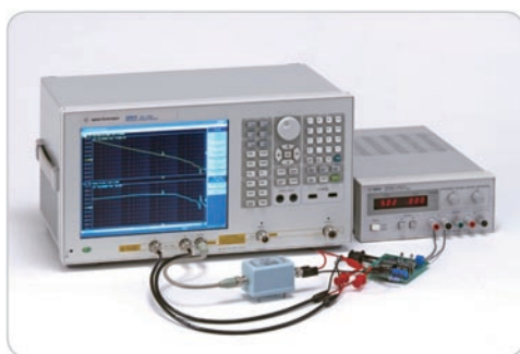
在增益相位测试端口上进行的直流 – 直流转换器环路增益测量
